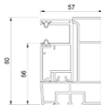
Coulisse (PVC) unilatérale - Trappe de révision RS de l'extérieur. MK933 + MK9760
